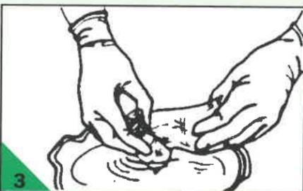
3. En portant les gants fournis (les gants sont plus efficaces sur des mains sèches), déchirer le sachet d'aluminium le long du pointillé. Sortir **Python Wrap** du sachet et faire tremper dans l'eau chaude pendant 20 secondes.
